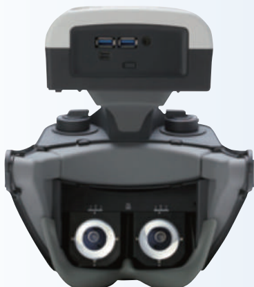
重さ1.8kgの 可搬型ヘッドマウント型視野計
